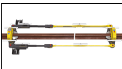
▲ Modulär 70 tons rälsdragare håller spåret i neutral längd under svetsningsarbetet.
