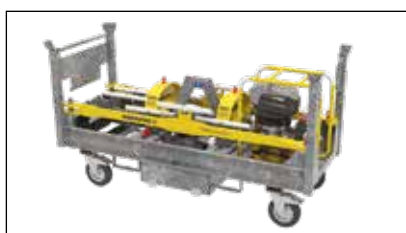
▲ Förvarings- och transportram RP70ATF tillsammans med rälsdragare, pump och möjlighet att säkert förvara slangsetet i ett låsbart förvaringsutrymme under ramen.
